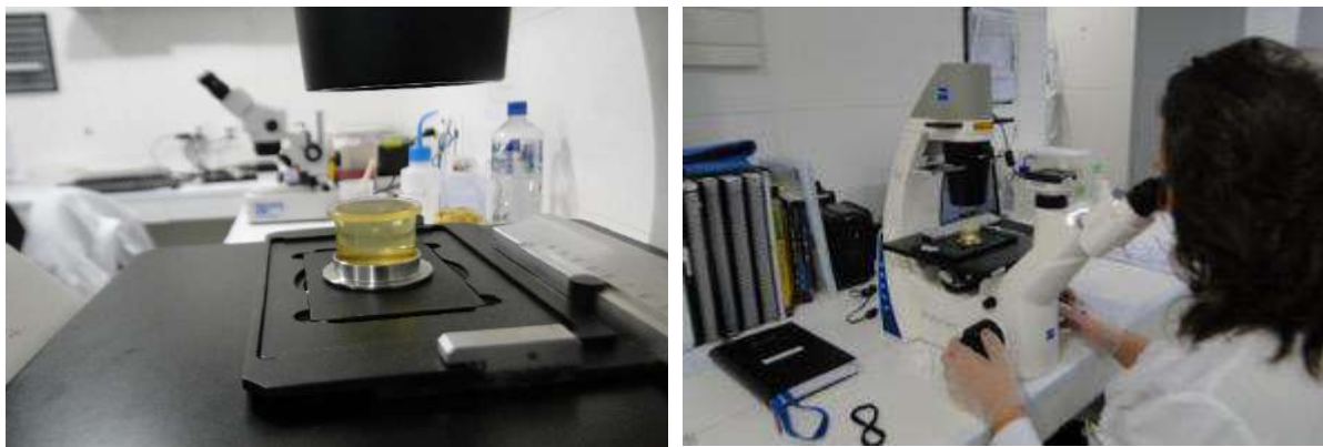
Fotos 3.2.1-3 e 3.2.1-4. Amostra na câmara de sedimentação de Utermöhl e contagem do fitoplâncton em microscópio invertido.
